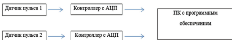
Рис.1 Схема устройства для определения СРПВ
