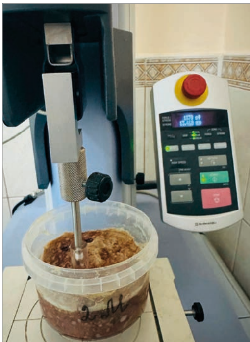
Fig. 1. Shimadzu EZ-LX texturometer (Japan).
