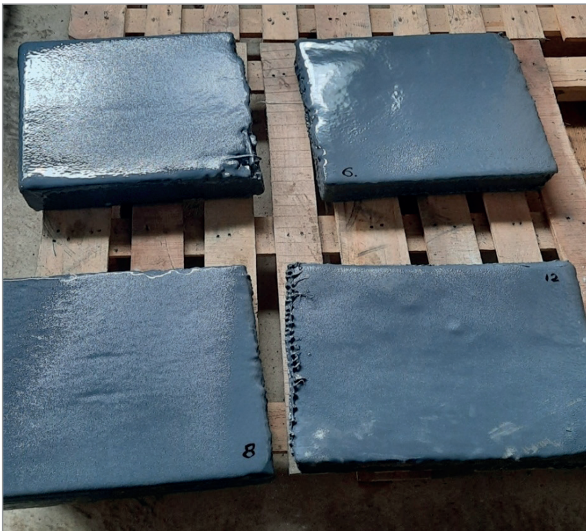
Рис. 6. Залізобетонні плити з нанесеним протиуламковим покриттям.
