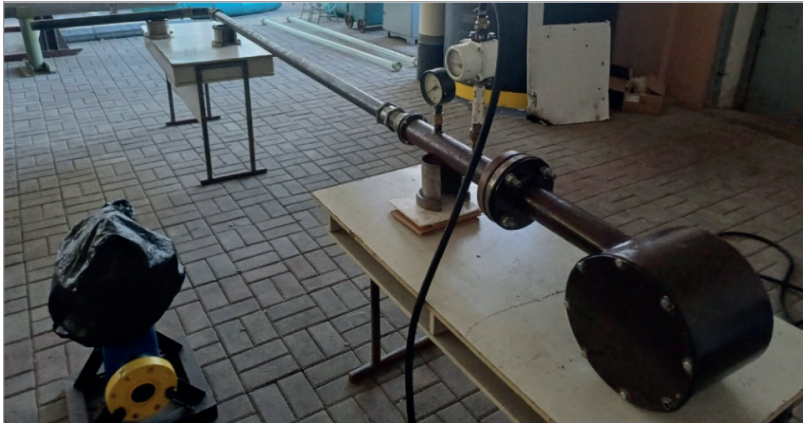
Рис. 2. Експериментальна установка визначення необхідного тиску для протягування байпасним поршнем ремонтної системи трубопроводом, який містить відвід
